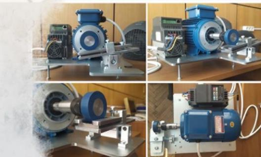
Рис. 1б. Стенд для испытания материалов на износостойкость, изготовленный на кафедре СМ12
