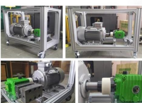
Рис. 3б. Установка для диспергирования, изготовленная на кафедре СМ12
